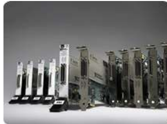
Abbildung 3-3: National instruments Datenerfassungskarten ( http://www.ni.com/daq )
