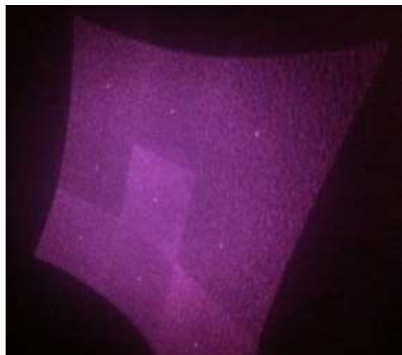
Abbildung 4-3: Infrarotmuster von das Kinect Laser ( http://www.anandtech.com/ )
